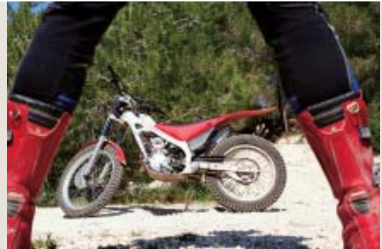
Montesa Cota 4RT: 250er-Trialer mit Straßenzulassung und Viertakt-Einspritzmotor von Honda. Die „Touren“-Sitzbank kommt von Schwarz
